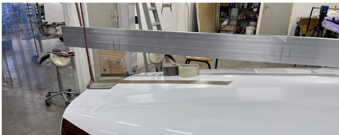
Ergebnis: Einstimmige Bewertung, dass der Kielsprung an den Spanten 2, 4, 6 und 9 den aktuellen Klassenvorschriften 2018 (Regel: 7.2.4) entspricht.
